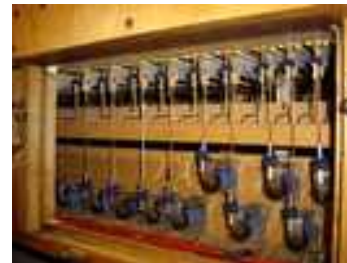
Aluminiumventile und Zugmagnete im Rückpositiv
